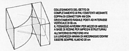
SEZIONE TIPO SULLO SCANNAFOSSO 1:20
