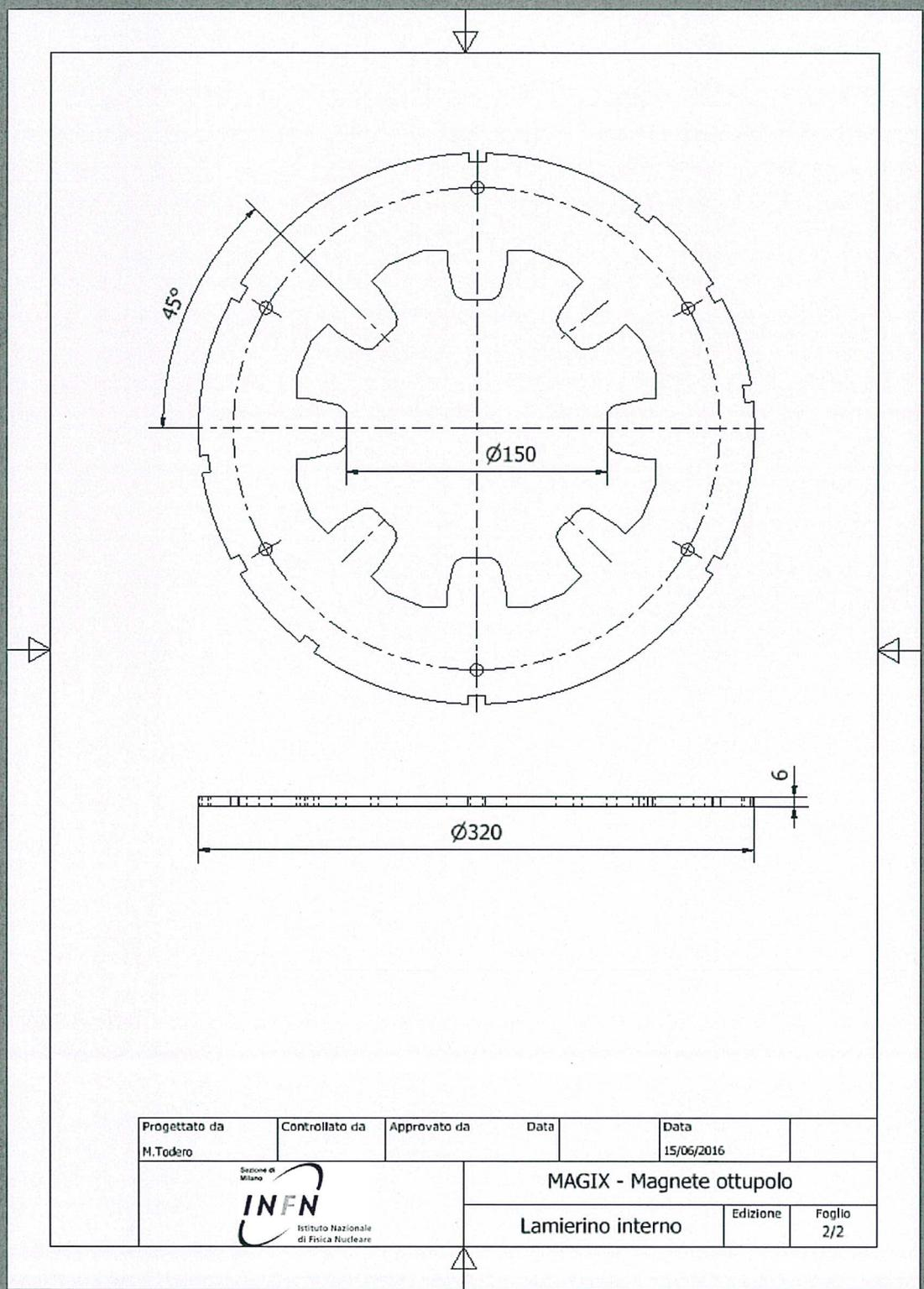
Fig. 2 Esempio di una dei lamierini interni che compongono il giogo del magnete.
