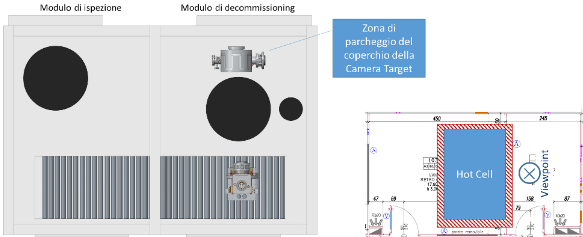
Figura 15: vista in sezione dall'alto della Camera Target scopercchiata posta all'interno del modulo di decommissioning (preliminare, di massima)
