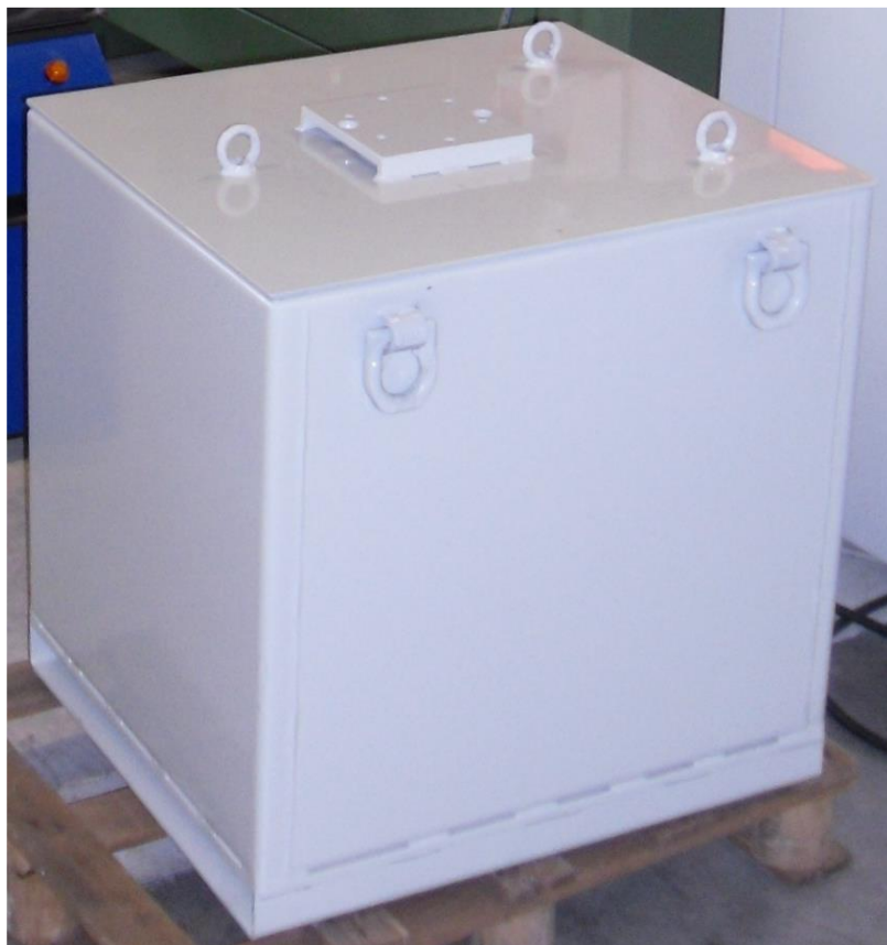
Figura 2: Il sarcofago contenente la Camera Target
