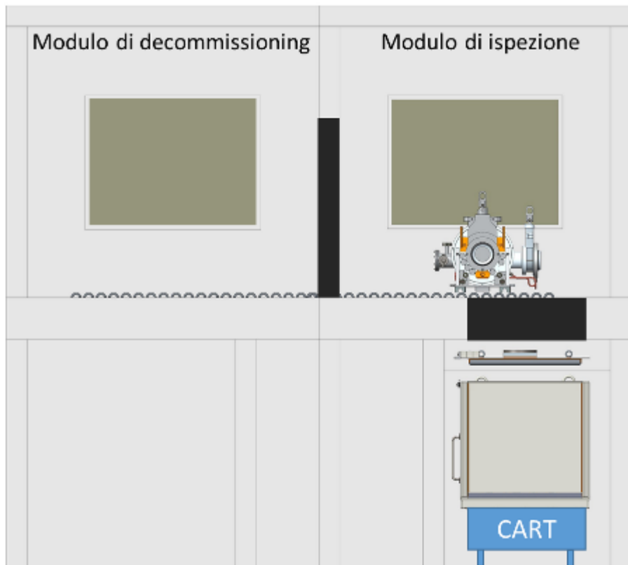
Figura 13: vista in sezione della Camera Target posta all'interno del modulo di ispezione (preliminare, di massima)
