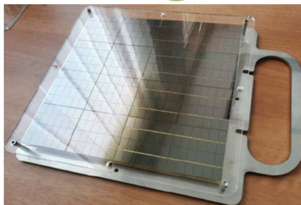
Fig. 2: PDU, assemblaggio di 16 TILE su circuito Mother Board
